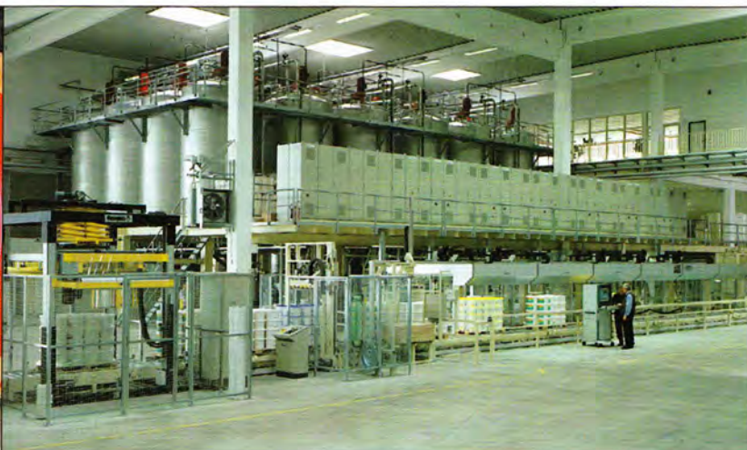
Verpackung und Kommissionierung vom Feinsten: Die moderne Farbabfüll- und Palettier-Anlage bei den Jonas-Farbenwerken
